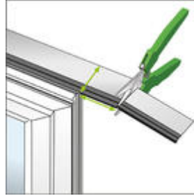
Bild 15: Folie im Eckbereich mit einem Breitenüberstand abschneiden
