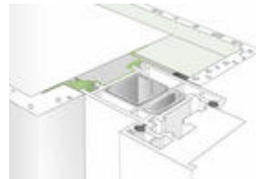
Bild 6: Befestigung der Folie innen wie Außenseite
