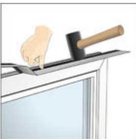
Bild 14: Geeignete Kederfolie in die äußeren Blendrahmen-Nuten einbringen
