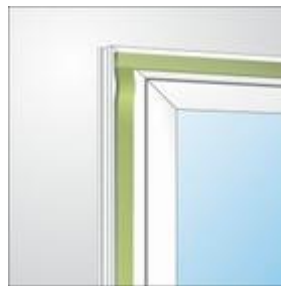
Bild 1: Bandverlegung bei der Fenstermontage
