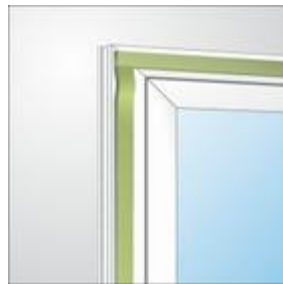
Bild 1: Eckauslegung bei der Fenstermontage
