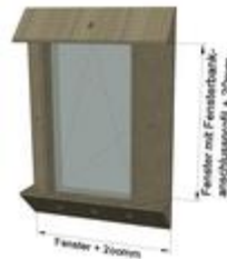
Bild 4: Maße Zuschnitt Zarge für 10 mm Fuge
